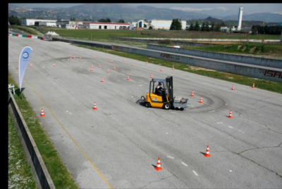
4. Kép - Jungheinrich EFG-V25 targoncára szerelték a tesztelt gumikat
